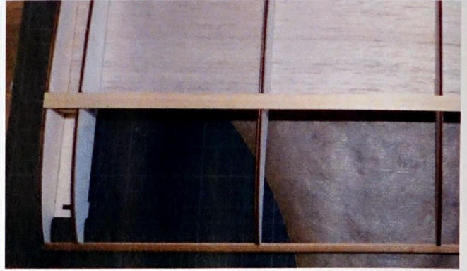
Die Kiefernleisten für Holme und Nasenleisten kommen übrigens einbaufertig aus dem Baukasten.
