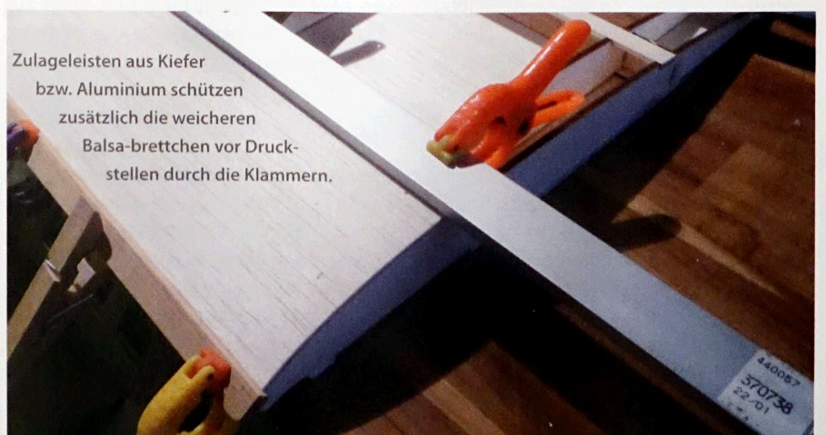
Dort, wo die Klemmweite von Wäscheklammern zu gering war, habe ich mit Bastelklammern aus Kunststoff gearbeitet.
