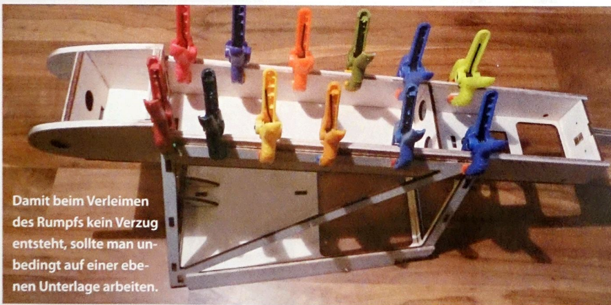
Zulageleisten aus Kiefer bzw. Aluminium schützen zusätzlich die weicheren Balsabrettchen vor Druckstellen durch die Klammern.
