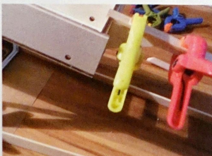
Dort, wo die Klemmweite von Wäscheklammern zu gering war, habe ich mit Bastelklammern aus Kunststoff gearbeitet.
