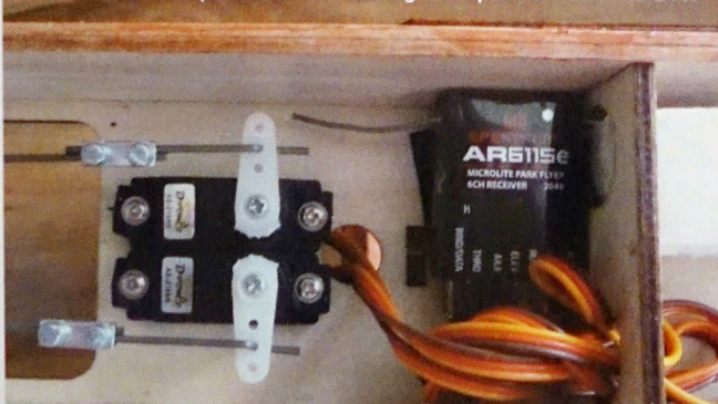
Bei den Servos empfiehlt aerobel die 9-g-Exemplare D-Power AS-218.
