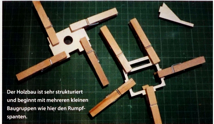
Die lasergeschnittenen Holzteile lassen sich mit einer scharfen Klinge einfach aus den Brettchen trennen.
